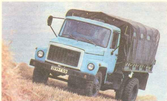
ГАЗ-33073 с V-образным бензиновым двигателем предназначен для перевозки 14 пассажиров.
