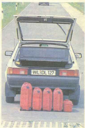
Загрузить багажник трудно: слишком высоко от земли нижняя кромка проема.
